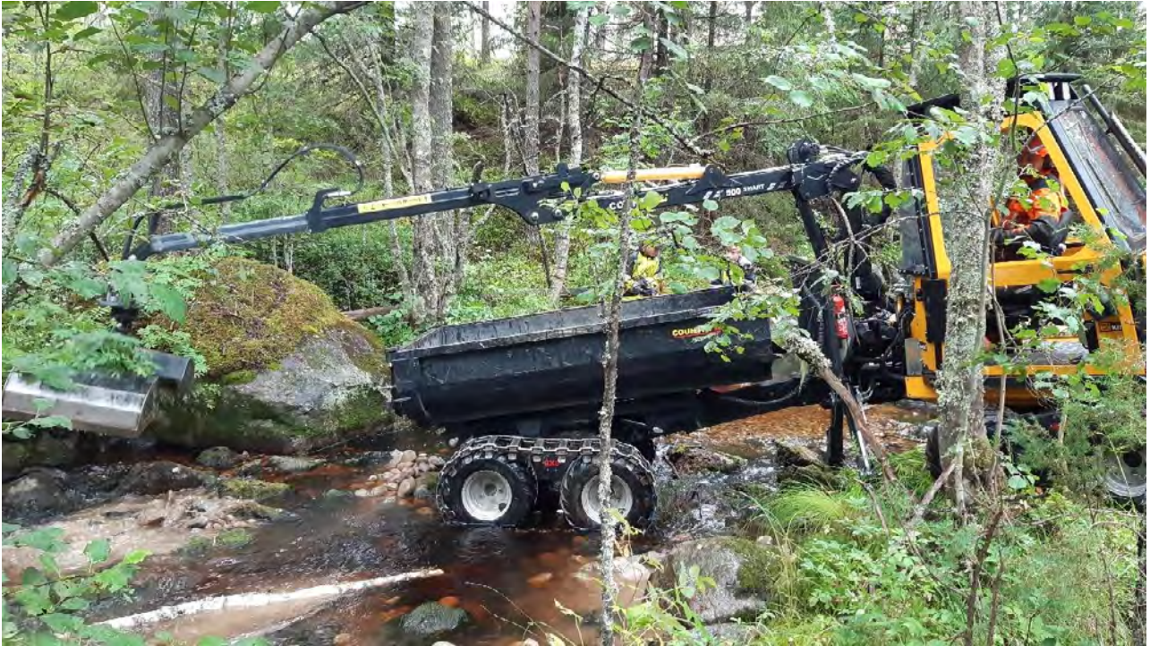
Pienmetsäkoneella sora ja poikaskivi voitiin kipata suoraan käärrystä tai levittää kuormaajan kahmarikauhalla.
