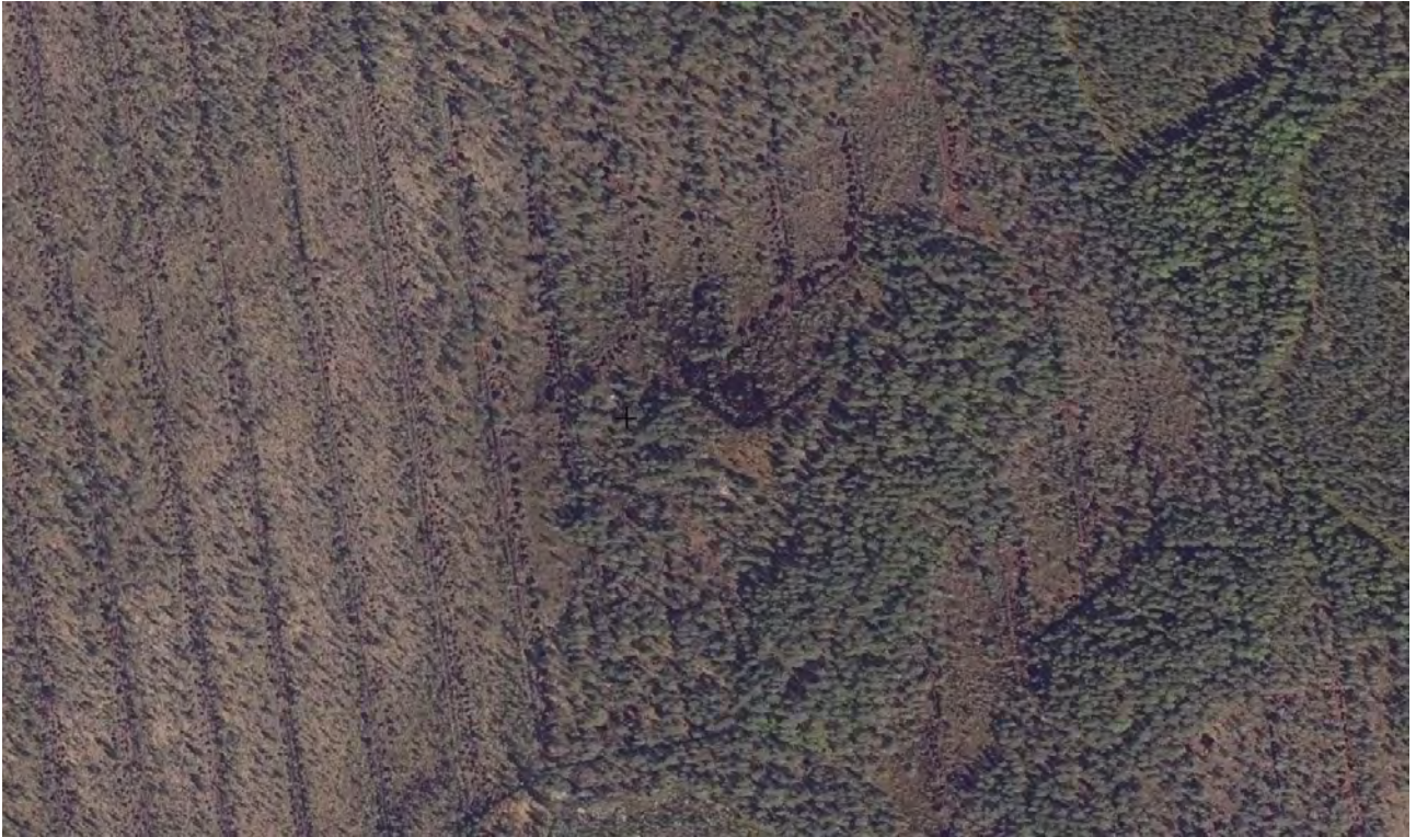
Ilmakuva ennallistetulta Ohrasuolta. Vanhojen ojien ympärillä näkyy kaivuujälkiä, joista on otettu turvetta ojien tukkimiseen. Keskellä kuvaa olevaan kohtaan on muodostunut avovettä. ©Maanmittauslaitos 2022.
